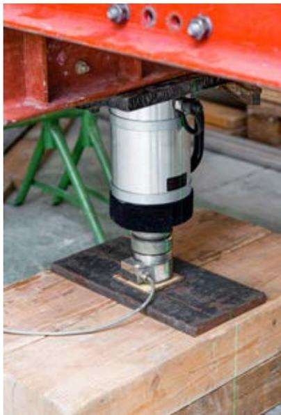
Beim Belastungstest wird ordentlich Druck gemacht: Ein Hydraulikzylinder kann bis zu 38 Tonnen Last erzeugen. Zwei davon sind in Limbach im Einsatz
