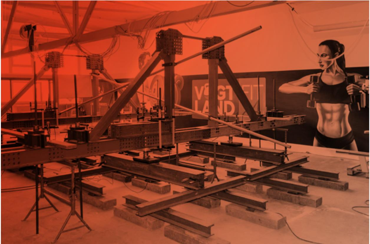
Das Stahlgerüst steht im Laufe der vier Tage an zwei verschiedenen Positionen, um alle kritischen Punkte zu untersuchen. Am Ende der Experimente steht fest: Die Decke der ehemaligen Eisengießerei ist stark genug, um ein Fitnessstudio zu tragen
