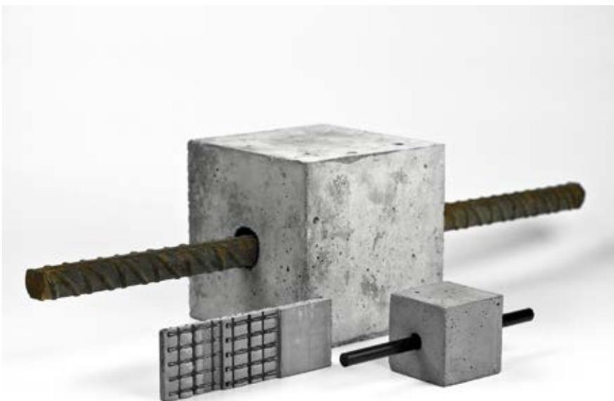
Im Vergleich zu Stahlbeton (großer Würfel links) spart Carbonbeton (kleiner Würfel und Platte) bei gleicher Leistungsfähigkeit bis zu 80 Prozent Material
