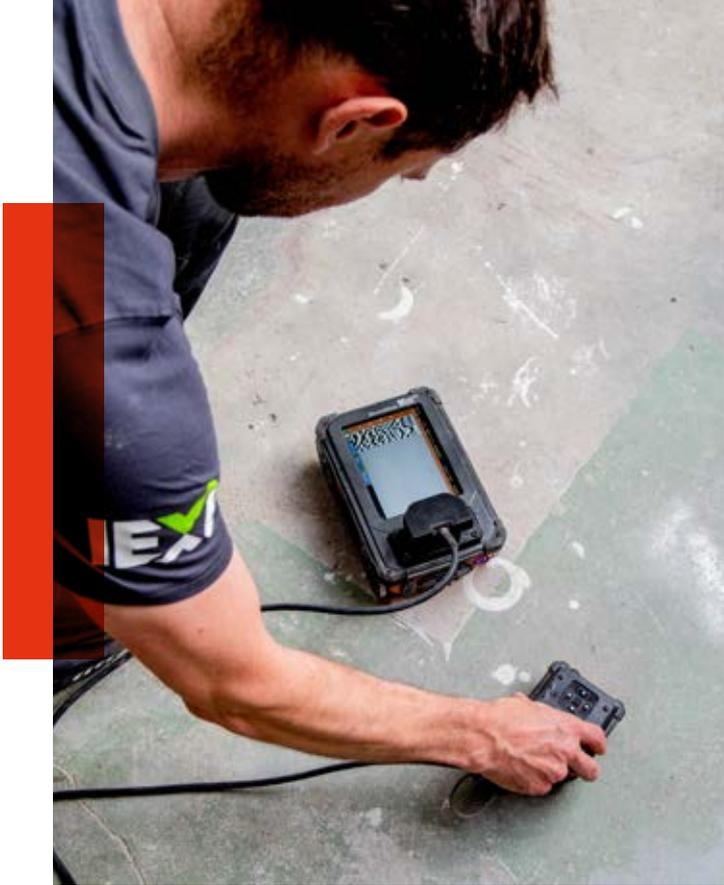
Gunter Hahn analysiert mit einem Impuls-Echo-Radar die Decke über dem ersten Geschoss und sieht so, wo im Inneren des Betons die Stahlbewehrung verläuft. Das muss er wissen, um eine geeignete Position für den Stahlrahmen und die Verankerungspunkte zu bestimmen
