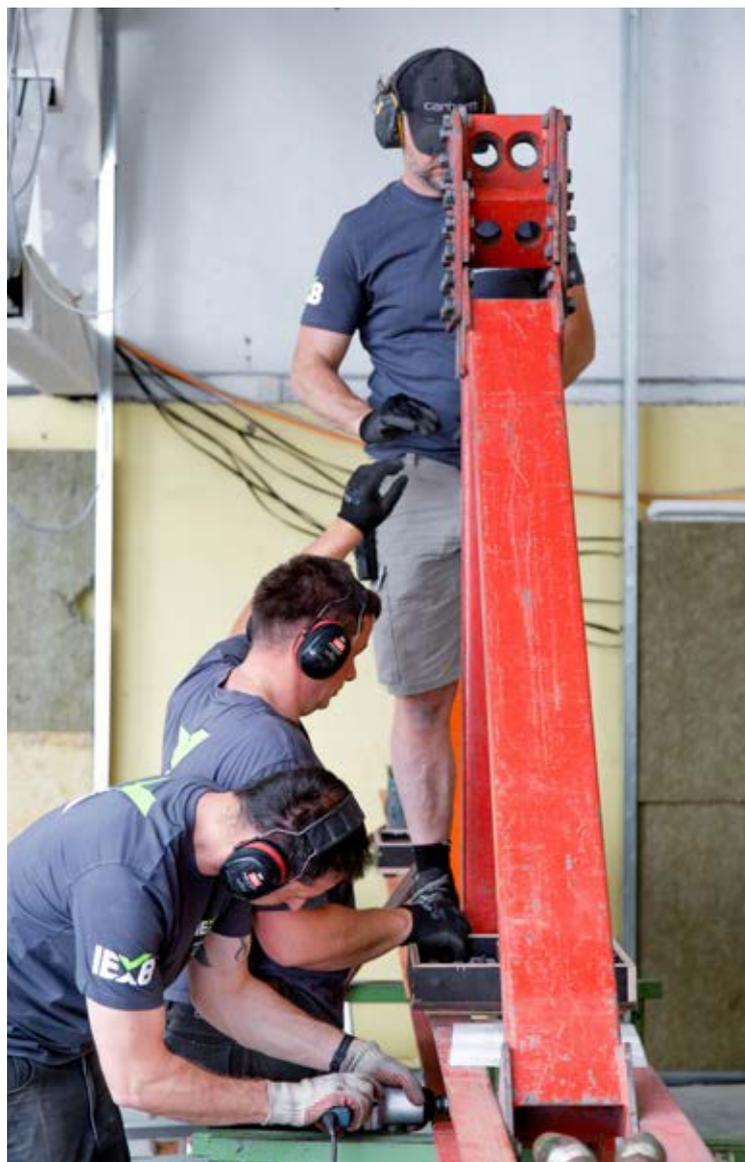
Als Hahn (vorne links) die Muttern mit einem Schlagschrauber befestigt, rattert es laut. „Zeit für die ‚Mickymäuse‘“, ruft Fischer, damit sich alle den Ohrenschutz aufsetzen
