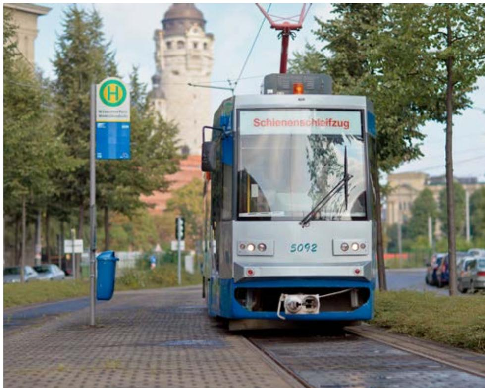
Werden Schienenunebenheiten frühzeitig erkannt, können sie durch einen Schienenschleifzug zügig und kostengünstig behoben werden
