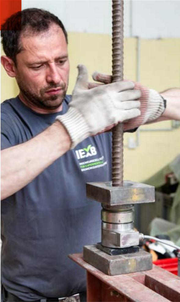
Hahn verankert die Stahlträger mit den Eisenstangen fest am Boden. Damit die Stangen präzise und gerade an der richtigen Position halten, setzen die Ingenieure Traversen, Ankerplatten und Muttern ein
