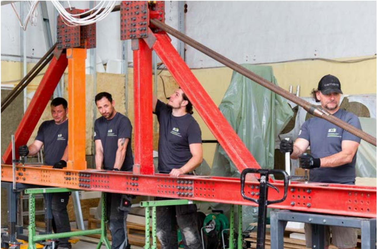
Um die Traglast zu überprüfen, errichtet das Team von IEXB ein neun Meter langes Stahlrahmensystem. Es dient als Rückverankerung für die hydraulischen Pressen, welche genau dort auf den Boden drücken, wo es kritisch werden könnte. Diese Stellen haben die Bauingenieure in der Vorplanung berechnet. Im Bild v. l.: René Janke, Gunter Hahn, Markus Fischer und Patrick Winkler
